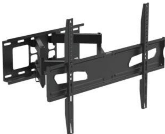
support mural, correspond pour écran plat, 81 cm, 32 pouces, 177 cm, 70 pouces, charge admissible jusqu'à 25 Kg, niveau à bulle, norme VESA, intervalles entre les trous 200 x 100 mm, 200 x 200 mm, 300 x 100 mm, 300 x 200 mm, 300 x 300 mm, 400 x 100 mm, 400 x 200 mm, 400 x 300 mm, 400 x 400 mm, 600 x 200 mm, 600 x 300 mm, 600 x 400 mm, inclinable, Inclinaison 10 degrés, pivotant
